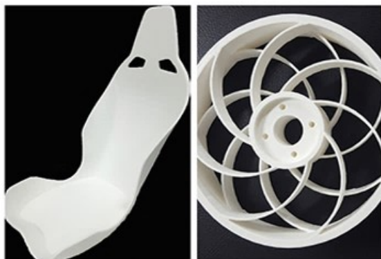
제주혁신센터의 설비 지원으로 설계된 무동력차의 3D 프린터 결과물. Seat와 Wheel.
